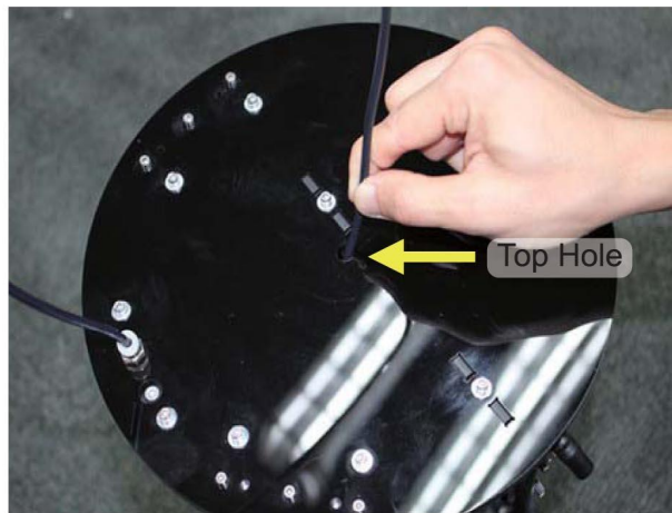
Krok 2: Druhá strana trubice vložte do diery vo vrchnej časti tlačiarne.
