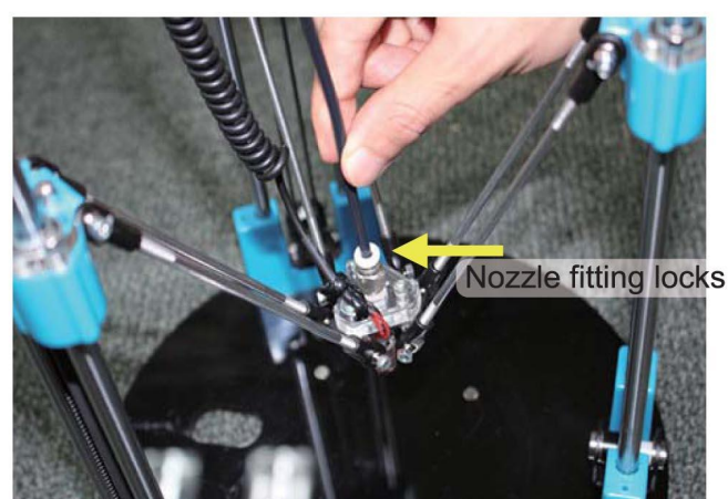
Krok 4: Uchyte trubicu filamentu na konci špičky
